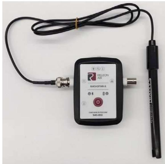
**Рис. 5.** Датчик электропроводимости
