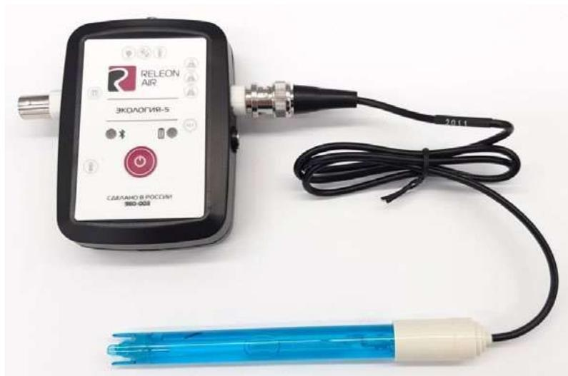
**Рис. 9.** Датчик водородного показателя (pH)
