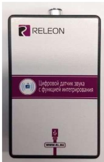
**Рис. 7.** Датчик звука
