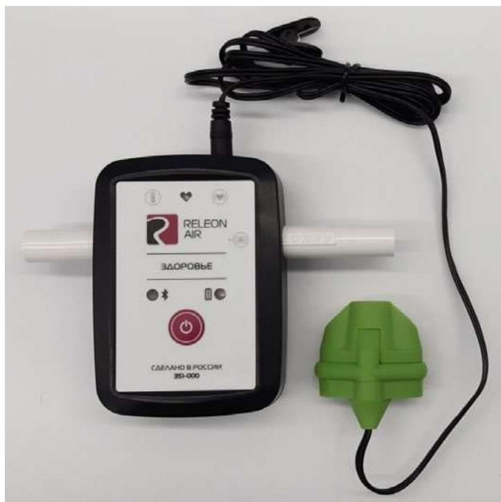
**Рис. 14.** Датчик пульса
