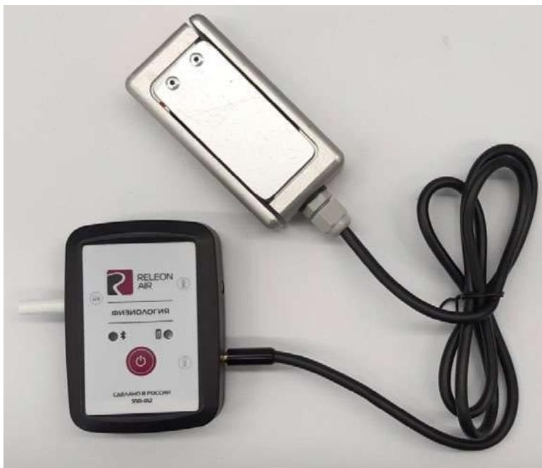
**Рис. 17.** Датчик кистевой силы (эргометр)
