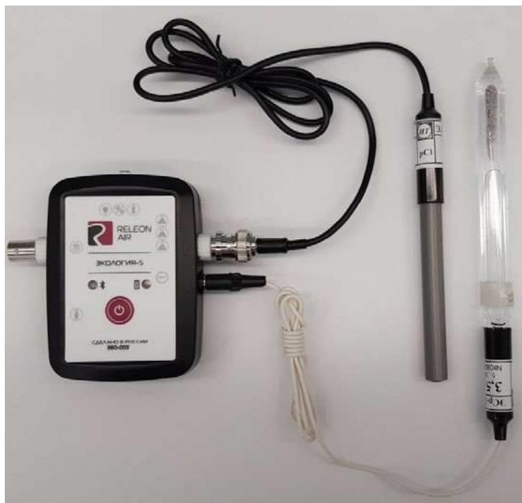
**Рис. 10.** Ионоселективный датчик
