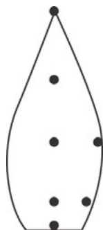
Рис. 1. Точки измерения температуры пламени
